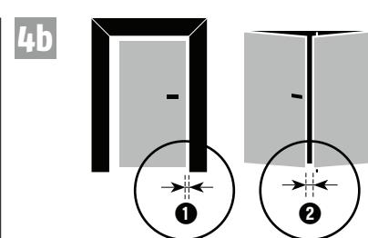
Dichtung kürzen im ausgelösten Zustand:
