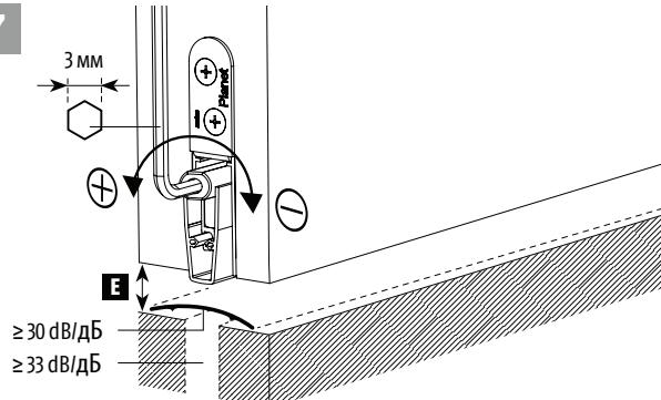
Einstellen Hub mit Inbuschlüssel (3 mm), Bodenanpressung vermeiden! (siehe Dichtungshöhe **E**), Funktionskontrolle
