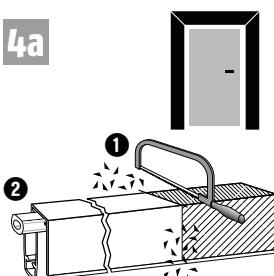
① Dichtung kürzen, Späne entfernen; ② Funktionskontrolle
