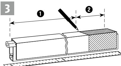
Vorbereitung zum Kürzen: ① Dichtung 1–2 mm kürzer als Türbreite; ② Kürzmaß: bis zur nächsten Lagerlänge (max. 125 mm)
