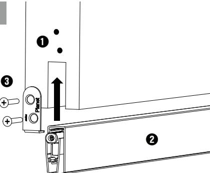
Montage der Dichtung: ① vorbohren der Schraubenlöcher; ② Dichtung einlegen; ③ Haltewinkel befestigen
