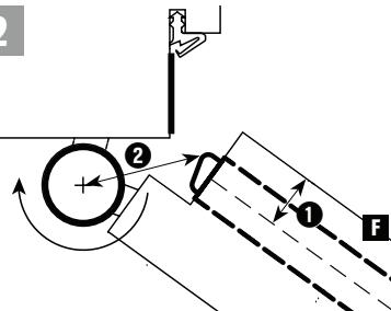
① Nut möglichst nah zur Zargendichtung (Achtung: Mass **F**, Seite 1) ② Spitze vom Band abgewendet
